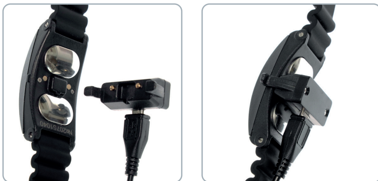
Рисунок 7. Подключение прибора СПРВ-НБ-МТ к ЗУ
