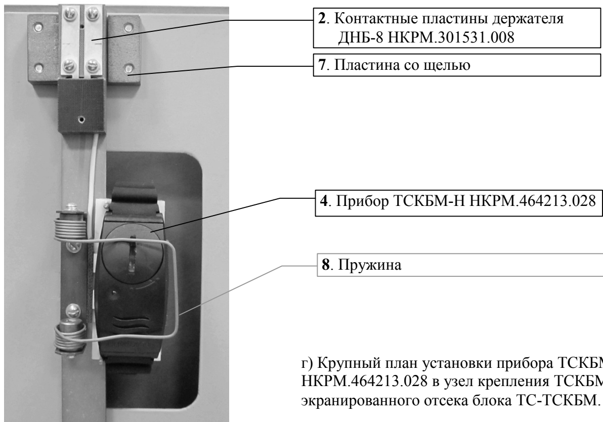
Рисунок 2.25(в, г)- Установка прибора ТСКБМ-Н НКРМ.464213.028 в узел крепления ТСКБМ-Н экранированного отсека блока ТС-ТСКБМ
