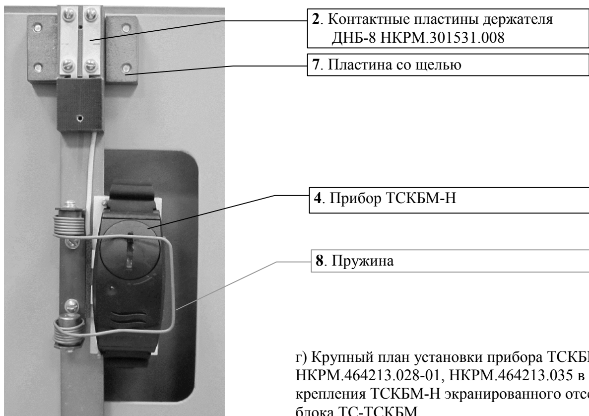
Рисунок 2.4.2.2(в, г) – Установка прибора ТСКБМ-Н в узел крепления ТСКБМ-Н экранированного отсека блока ТС-ТСКБМ
