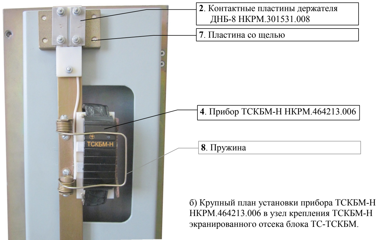
Рисунок 2.4.2.2(а, б) – Установка прибора ТСКБМ-Н НКРМ.464213.006 в узел крепления ТСКБМ-Н экранированного отсека блока ТС-ТСКБМ.
